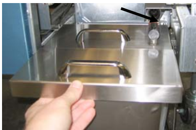
4. ábra: Helyezze az fedelet az edényre és csúsztassa az olajfelvevő csövet az elszívótartály csatlakozójához.
