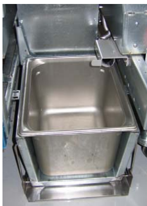
3. ábra: Helyezze a belső olajtartály edényét az olvasztóegységbe.
