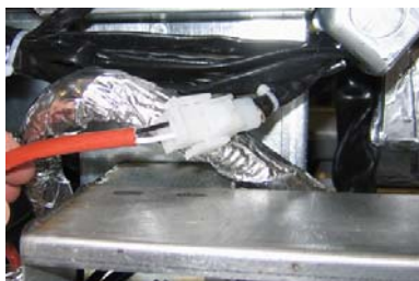
6. ábra: Csatlakoztassa a fehér két tűs csatlakozókat és csatlakoztassa a fekete dugót a dobozhoz a képen látható módon. * Megjegyzés: a fekete csatlakozó helye letérhet a képen láthatótól.
