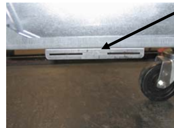
1. ábra: Csatlakoztassa az igazítókonzolt az ATO-doboz tartójának aljához.
